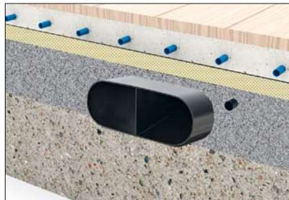
Flatkanal i utjevningssjikt (iht. DIN 18560-2)
